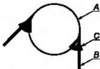
А — шкив, В — канат, ремень; С — защитный козырек
